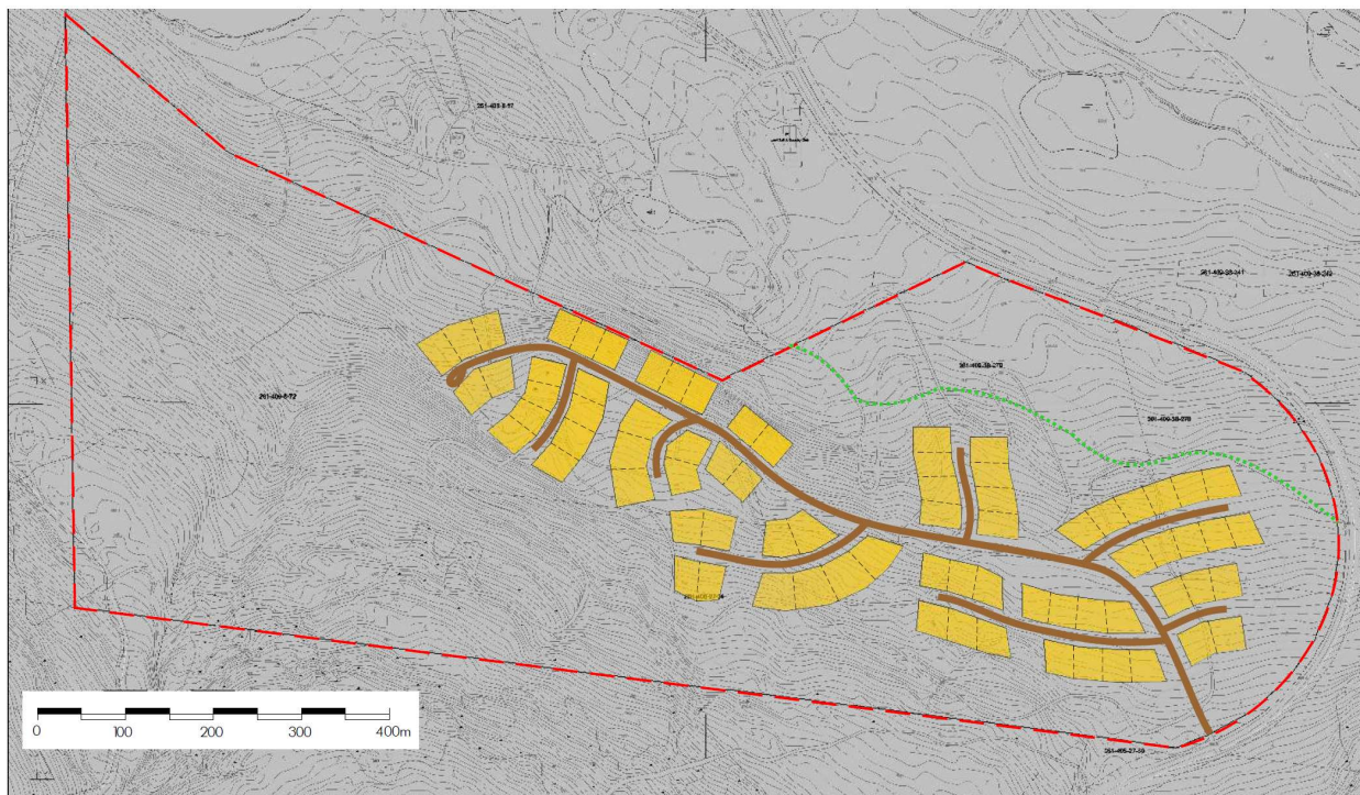
Kuva 16. Kaavarunkoluonnos 1 pohjautuu kokoojakatuun joka yhdistyy Levin ympäristiehen suunnittelualueen kaakkoiskulmasta – jyrkästi kaartuvien ja viettävien mutkien väliseltä lyhyeltä tasanteelta. Tässä vaihtoehdossa tontteja muodostuisi 76 kpl.
